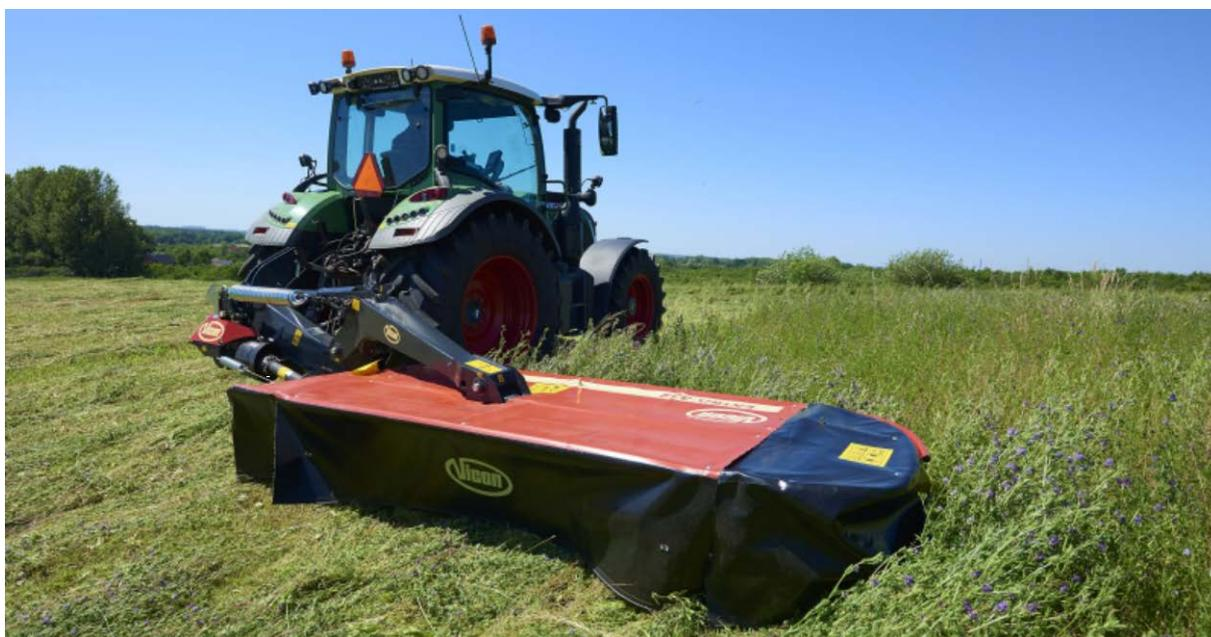
*El nuevo ajuste hidráulico de las segadoras EXTRA 300 aglutina las ventajas de la respuesta inmediata de los sistemas de muelles con el simple y preciso ajuste hidráulico.*
