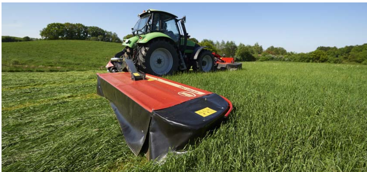
Vicon EXTR \Delta 340 con 4,0 m de ancho de trabajo.
